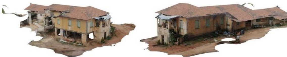
Figura 4 e 5- Modelo 3D gerado através da nuvem de pontos com textura.
